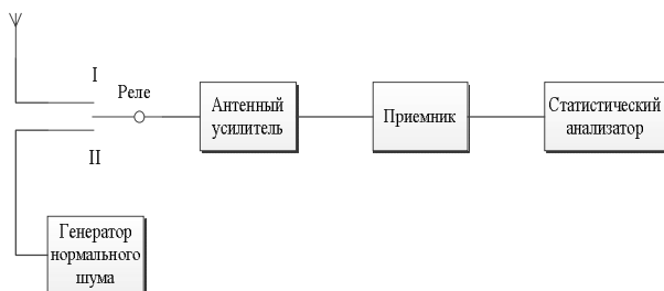
Рисунок 1 – Блок-схема аппаратного комплекса для исследования статистических свойств узкополосных случайных процессов [6]
