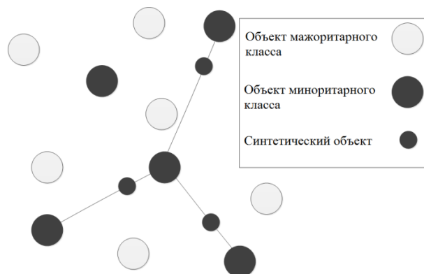
Рисунок 1 – Схема генерации синтетических объектов в SMOTE-алгоритме
