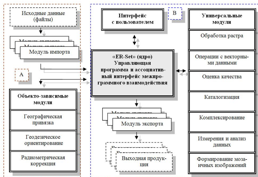
Рисунок 1 – Архитектура программного комплекса на основе платформы «ER-Set»
