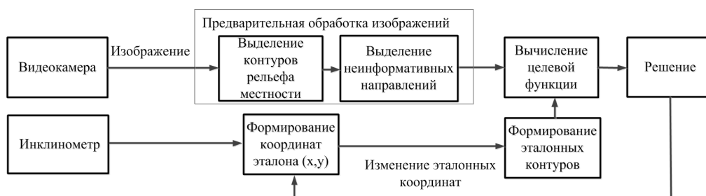
Рисунок 1 – Структурная схема системы видеопозиционирования объектов
