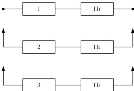
Рисунок 1 – Структурная схема надежности системы
