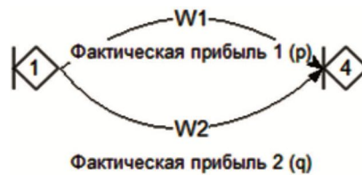
Рисунок 6 – Эквивалентная схема параллельно соединенных дуг с положительными случайными величинами
