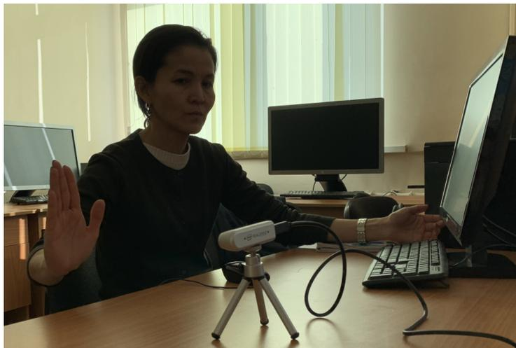
**Рисунок 6 – Пример захвата жеста руки человека сенсором RealSense D400**
