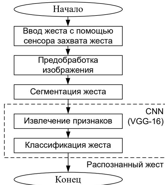
**Рисунок 1 – Блок-схема алгоритма работы предлагаемой системы распознавания статических жестов рук**
