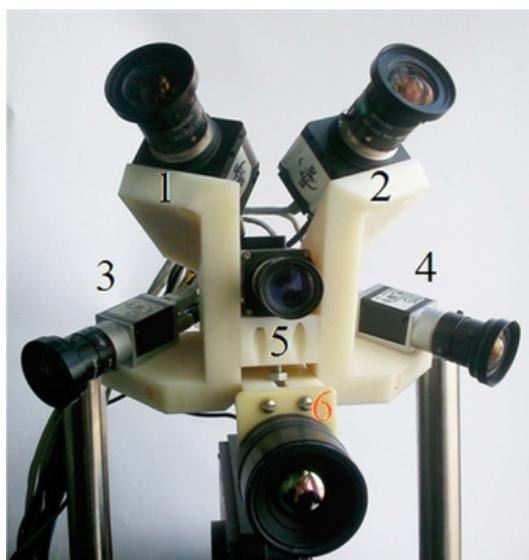
Рисунок 5 – Внешний вид макета СТЗ с распределенной апертурой
