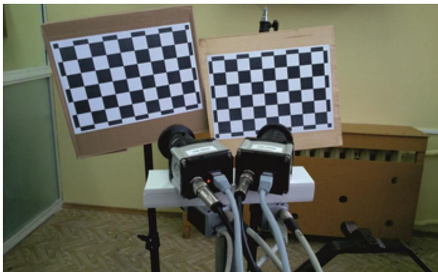
**Рисунок 1 – Вид камер и двух ТО с шаблоном типа «шахматное поле» [11] при съемке с точки размещения ВШК**
