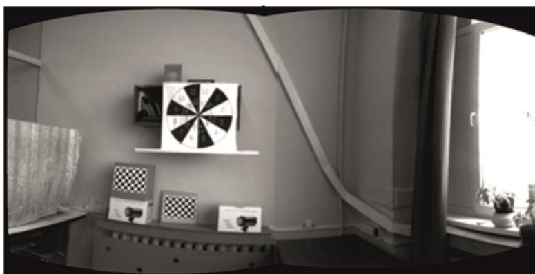
**Рисунок 2 – Результат формирования панорамы при фотограмметрической калибровке со вспомогательной камерой**
