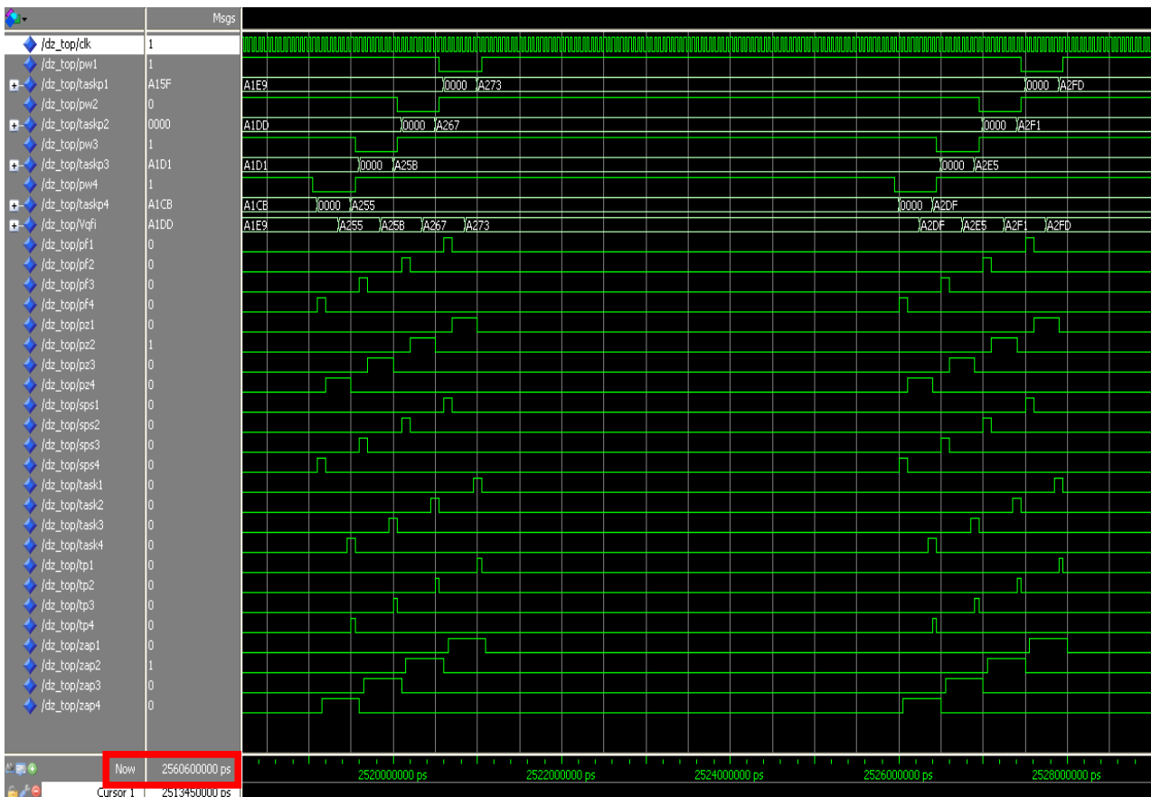
Рисунок 4 – Полученные временные диаграммы в среде ModelSim-Altera 10.0c Figure 4 – Obtained temporal diagrams in ModelSim-Altera 10.0c program
