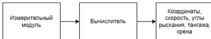
**Рисунок 1 – Блок-схема бесплатформенной инерциальной навигационной системы**
