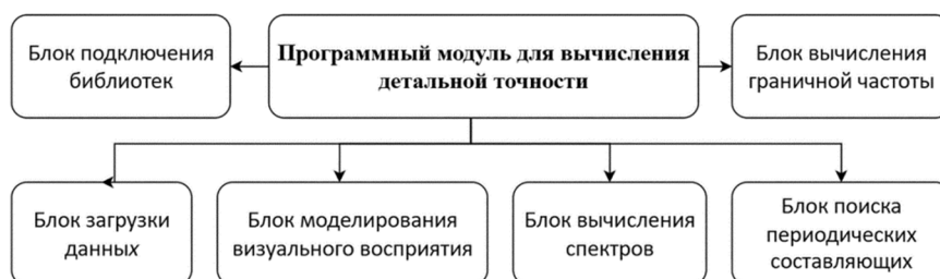
Рисунок 3 – Структура программного модуля оценки детальной точности
