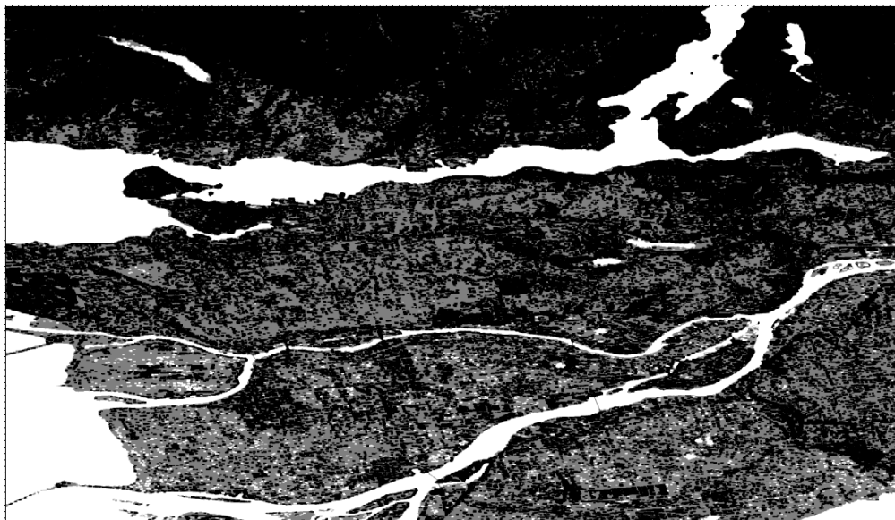
Рисунок 9 – Сформированная по данным ЦМР маска классов изображения № 1 (белый цвет – класс «вода», черный цвет – класс «не вода», серый цвет – класс «не определено») Figure 9 – Class mask for image №1 formed on DEM data (white colour – class «water», black colour – class «non-water», gray colour – class «undefined»)
