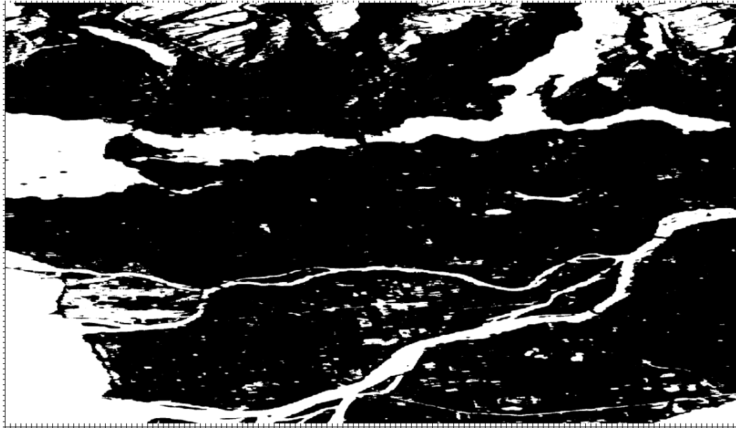
Рисунок 7 – Целевая классификация изображения № 1 на основе текстурной классификации по признаку гомогенности (белым цветом обозначен класс водной поверхности, черным – класс суши)
