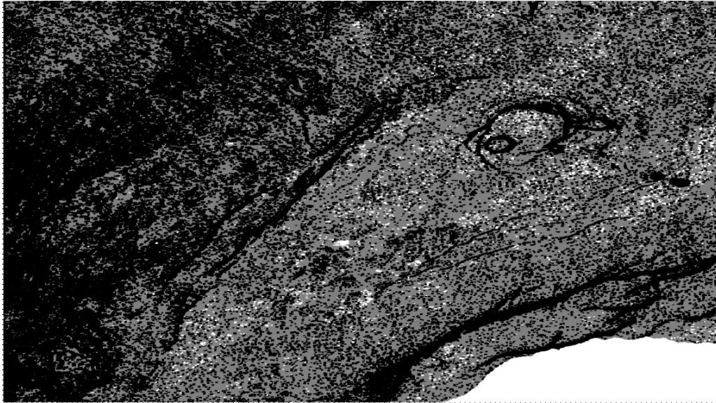
Рисунок 10 – Сформированная по данным ЦМР маска классов изображения № 2 (белый цвет – класс «вода», черный цвет – класс «не вода», серый цвет – класс «не определено») Figure 10 – Class mask for image №2 formed on DEM data (white colour – class «water», black colour – class «non-water», gray colour – class «undefined»)
