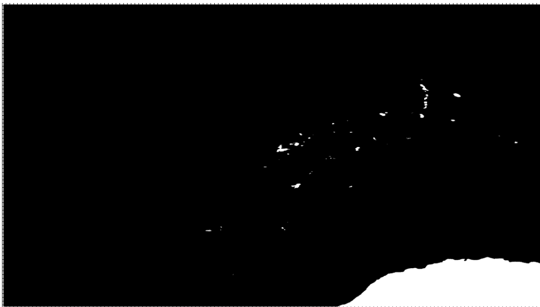
Рисунок 8 – Целевая классификация изображения № 2 на основе текстурной классификации по признаку гомогенности (белым цветом обозначен класс водной поверхности, черным – класс суши)
