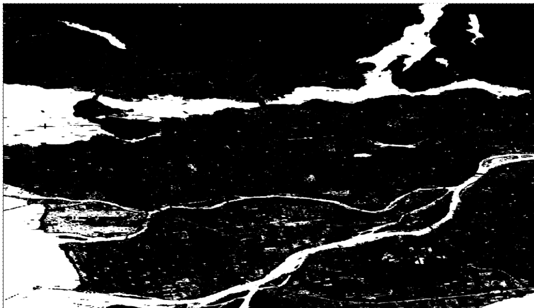
Рисунок 11 – Результат применения алгоритма повышения точности для поляриметрически классифицированного изображения № 1 Figure 11 – The result of accuracy improvement algorithm usage on polarimetrically classified image № 1
